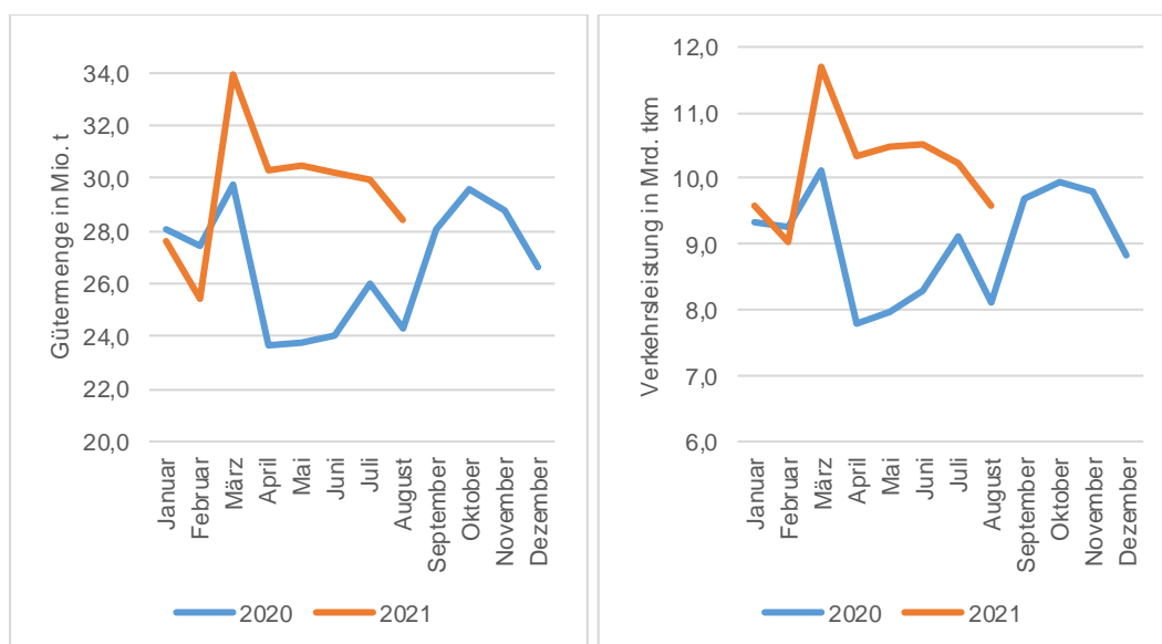
Abbildung 3.1: Entwicklung der Beförderungsmenge (linke Abb.) und der Verkehrsleistung (rechte Abb.) der Güterbahnen in Deutschland im Zeitraum von Januar 2020 bis August 2021
